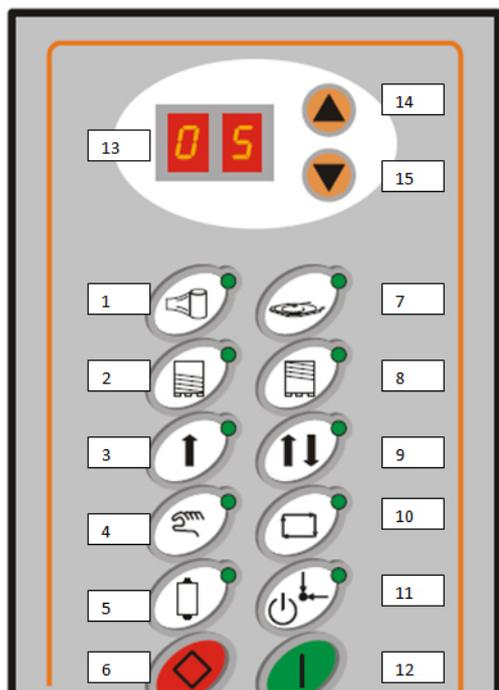
1. Attivazione carrello portabobina con frizione elettromagnetica (optional)
